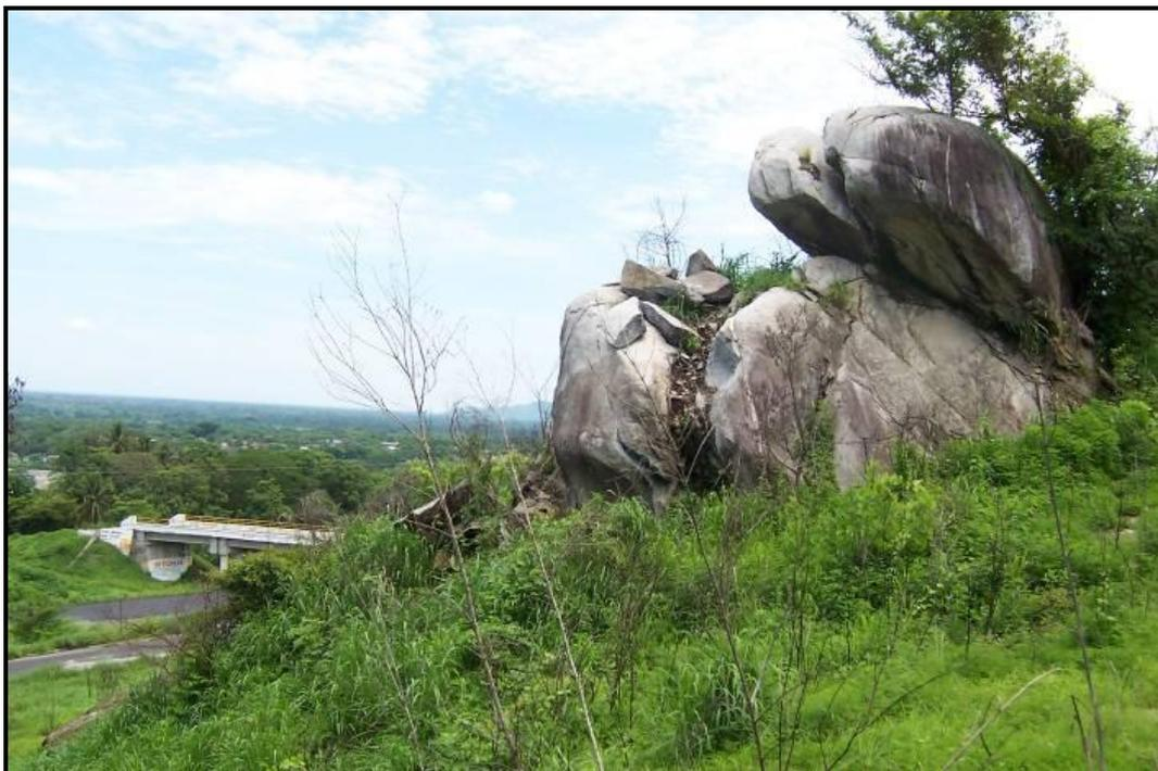
**Fotografía 2.20.-** Entronque a la Ciudad de Pijijiapan en la carretera federal No. 200 tramo Tapachula-Tonalá, en esta parte aflora el granito, el cual se encuentra fractura. Se observan bloques de 4m de largo por 2 de alto, y de 7m de largo por 6m de alto. La caída de los bloques sería al SW70°, y tiene una pendiente de 78°
