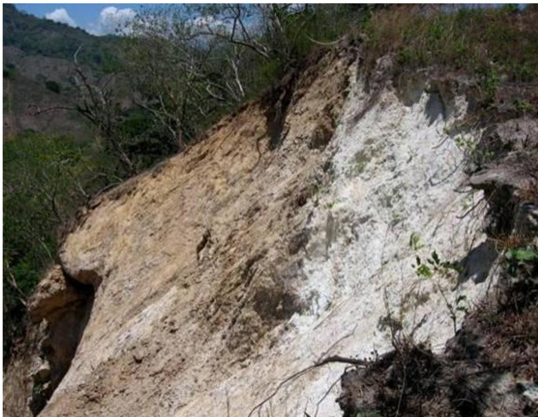
***2.3.- Granito fuertemente fracturado e intemperizado expuesto en una superficie de deslizamiento.***
